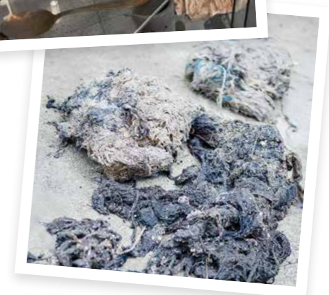
Fundstücke aus dem Rechenhaus im Klärwerk Ruhleben 2 (oben). Verstopft die Kanalisation: ein „Zopf“ aus allem, was nicht in die Toilette gehört (unten).
